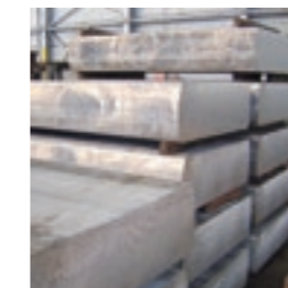
マグネシウムエレクトロン社製 マグネシウム合金スラブ Magnesium alloy slab manufactured by Magnesium Elektron Ltd.
